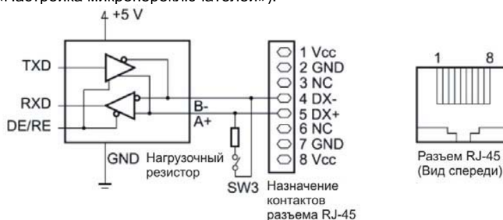
Рис. 2.18 Назначение контактов разъема RJ-45 (мама)
